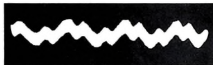
Bild 34. Charakteristisches Störspannungsozillogramm beim Messen des Fremdspannungsabstands
